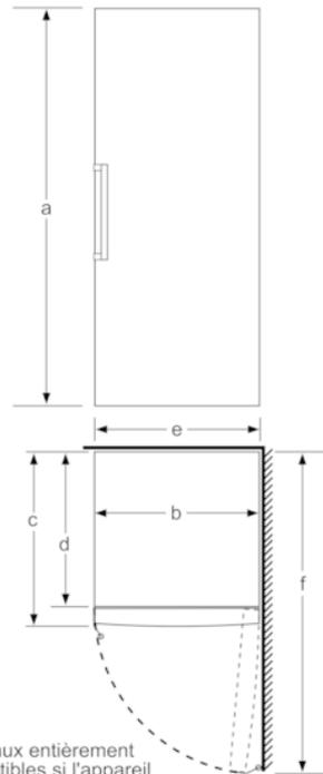
Plateaux entièrement extractibles si l'appareil est positionné directement contre un mur.
