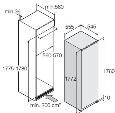
Dimensions de l'appareil et d'encastrement
